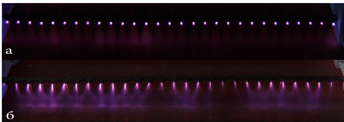
Рис.1. Свечение отрицательного (а) и положительного (б) коронных разрядов
