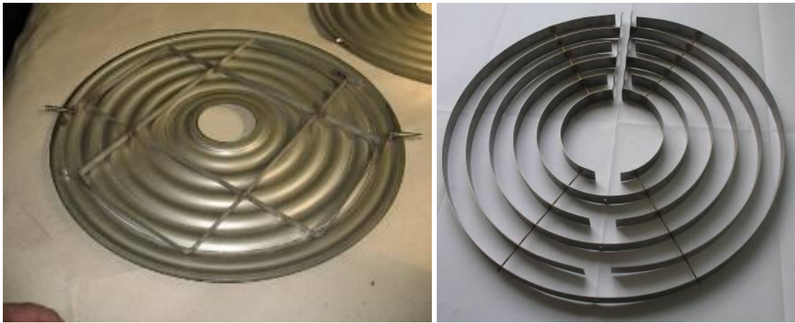
Рис.8 а) стандартный электрод с внутренней проставкой б) доработанная внутренняя проставка электрода
