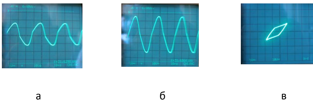
Рис. 4. Осциллограмма напряжения – а; осциллограмма заряда – б; осциллограмма параллелограмма Мэнли – в
