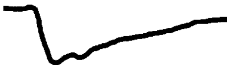
Рис. 5 – Кривая тока микроразряда с увеличенным активным сопротивлением.
